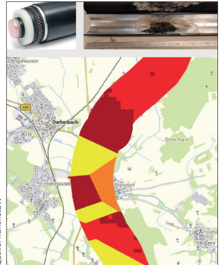
Bild 3: Blitzschutz für HGÜ-Kabel der Südlink-Trasse – oben links: HGÜ-Kabelaufbau (Beispiel: NKT A/S); oben rechts: Beschädigung Kabelmantel und Querschnittswasserperle aufgrund Blitzeinwirkung; unten: Hochrisikogebiet Schweinfurt/Oerlenbach – für diesen besonders gefährdeten Bereich erfolgte eine Untersuchung der Risikoreduktion durch Installation zusätzlicher Schutzmaßnahmen
